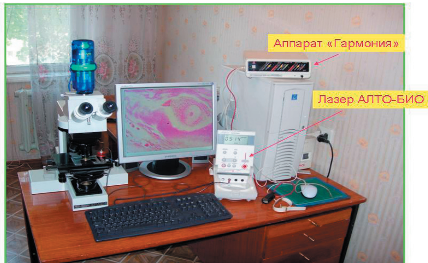
Рис. 1. Прижизненная интерференционная микроскопия нервной клетки речного рака. Анализ на компьютере регистрируемых ритмов золь-гель переходов при воздействии на клетку лазером аппарата «АЛТО-БИО» или при электростимуляции (аппарат «Гармония»)
