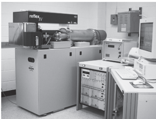
Рис. 4.18. Оборудование, необходимое для масс-спектрометрического анализа ( http://biophysics.uoguelph.ca/central/facilities.htm ) (пояснения в тексте)
