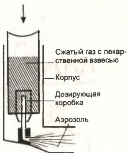
Рис. 50. Устройство аэрозольдозатора
