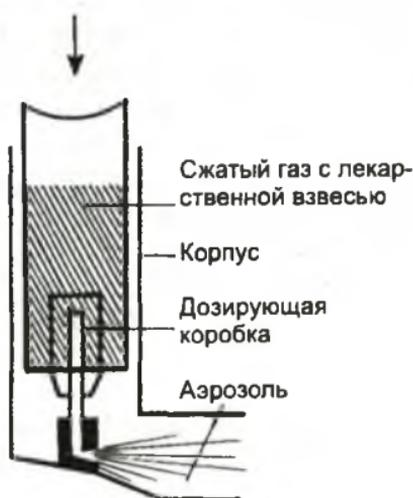
Рис. 50. Устройство аэрозольдозатора
