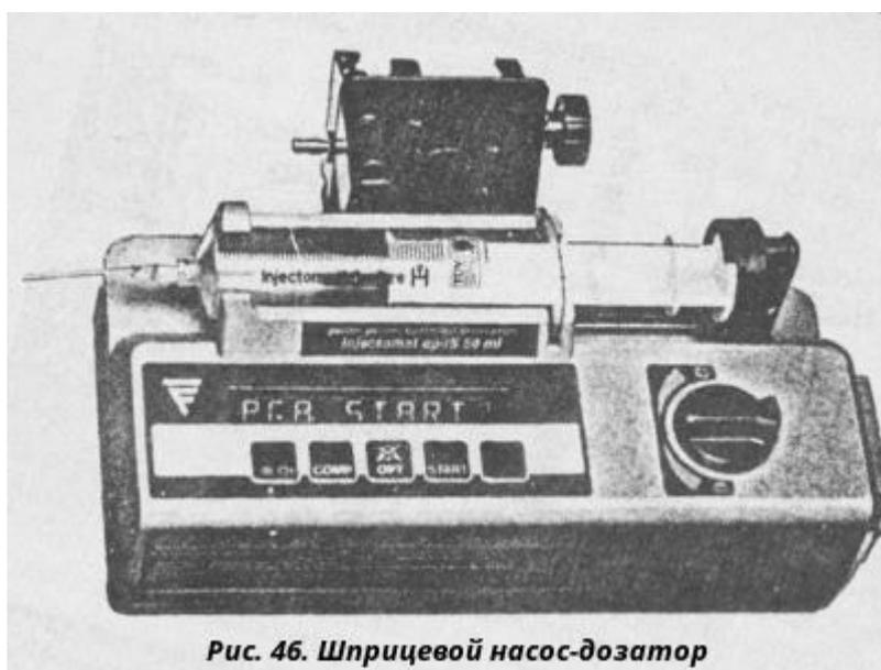
**Рис. 46. Шприцевой насос-дозатор**
