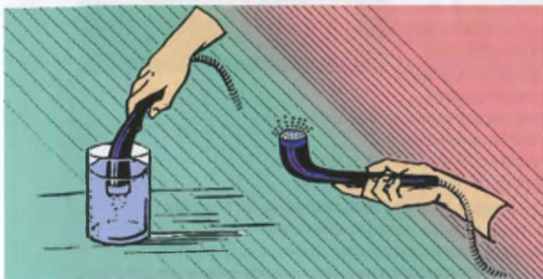
Рис. 6.24. Проверка исправности аппарата для ультразвуковой терапии
