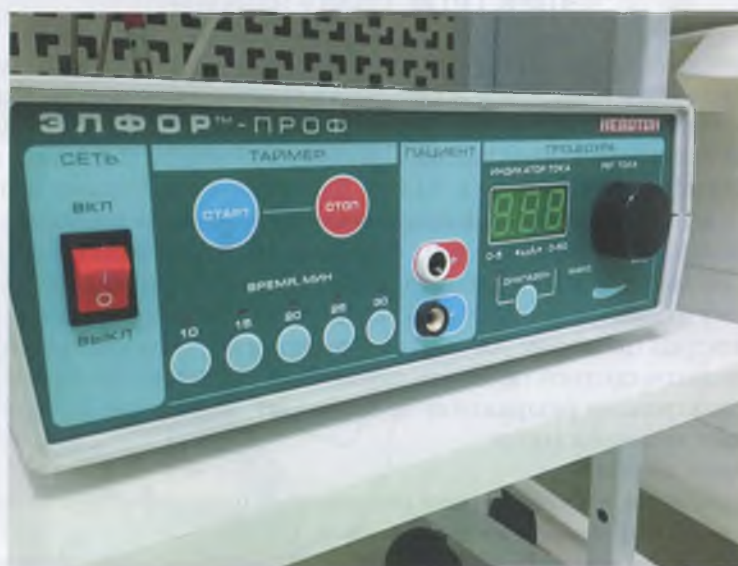
Рис. 6.11. Аппарат для проведения лекарственного электрофореза
