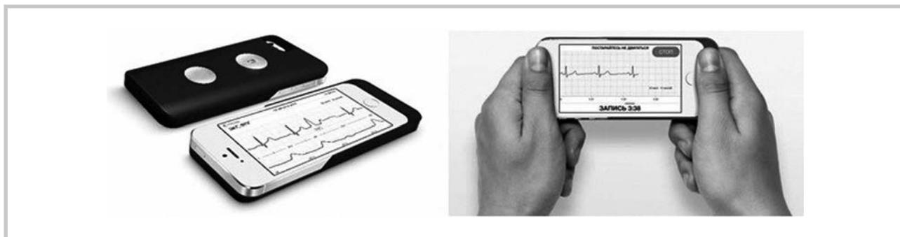
**Рис. 1.** Одноканальный портативный электрокардиограф CardioQVARK.
