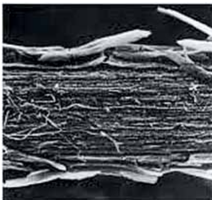
Рис. 1. Коррозия проволоки медной оплётки внутриматочного устройства, находившегося в полости матки 202 дня [Kosonen A. Corrosion of copper in uterus // Fertil. Steril. 1978. Vol. 30 (1). P. 59–65. PMID: 680184].
