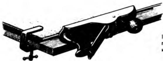
Рис. 5. Приспособление для застрагивания под прямым углом торцов деталей из полистирола и фанеры
